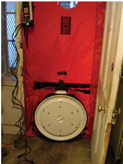
Blower door test.
